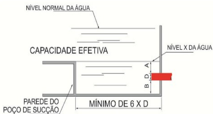
Figura B.2 – Tomada lateral de sucção para bomba principal
