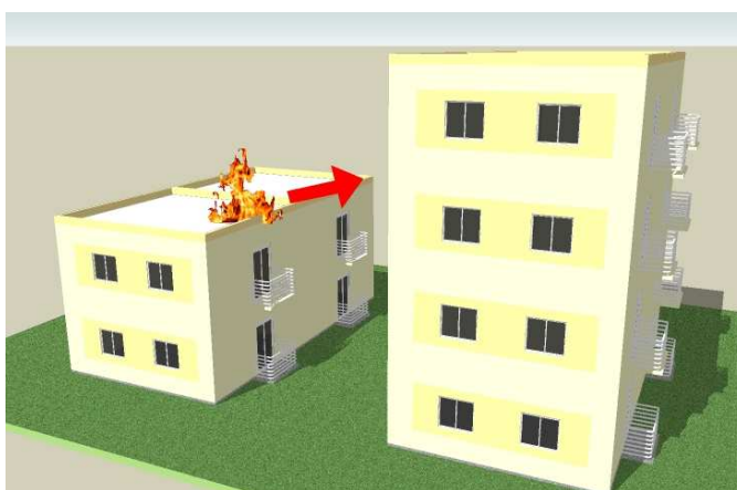
Figura 3 – Propagação entre cobertura e fachada
