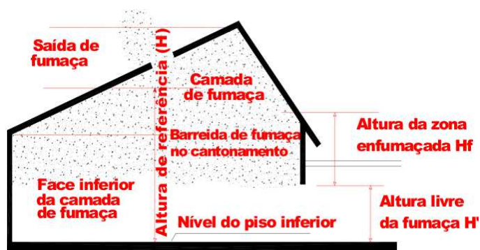
Figura 14 - Altura de referência, livre de fumaça e da zona enfumaçada.
