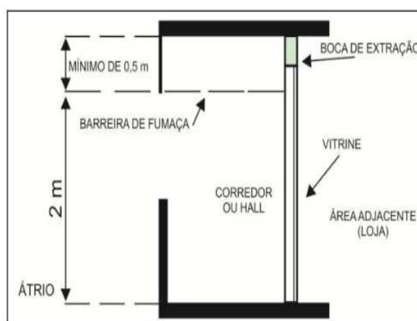
Figura 37 - Exemplo de locais diretamente abertos, porém separados do átrio por uma circulação horizontal
