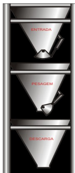
(figura ilustrativa e exemplificativa – balança de fluxo contínuo)
