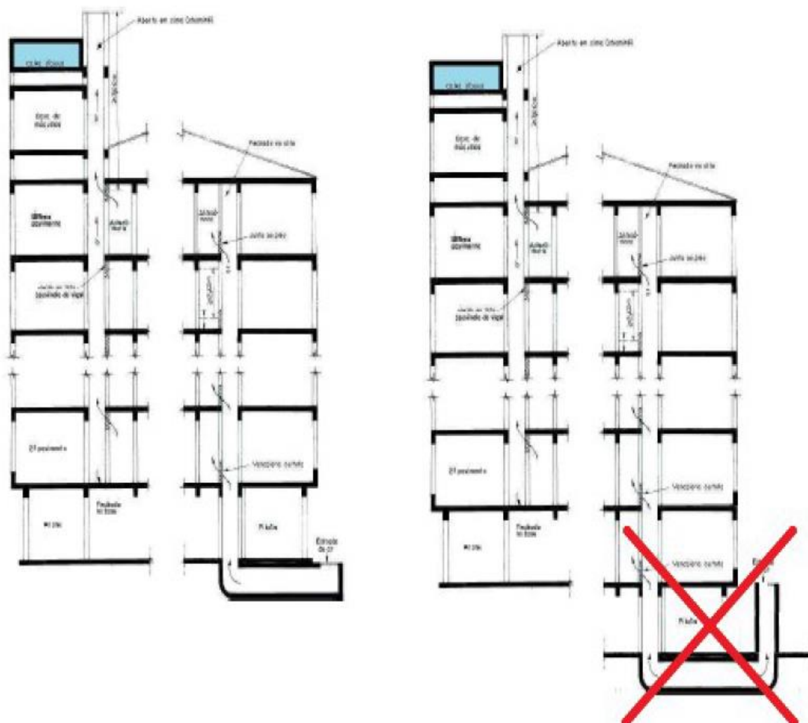
Figura 10-A — Exemplos de dutos de ventilação Figura 22-A — Exemplos de dutos de ventilação
