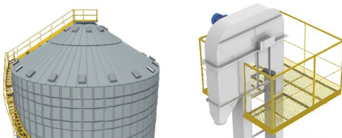
(Figura 4 – guardas no topo dos silos e dos elevadores)
